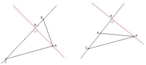
H est le pied de la hauteur issue de A. (AH) est la hauteur relative au côté [BC].
